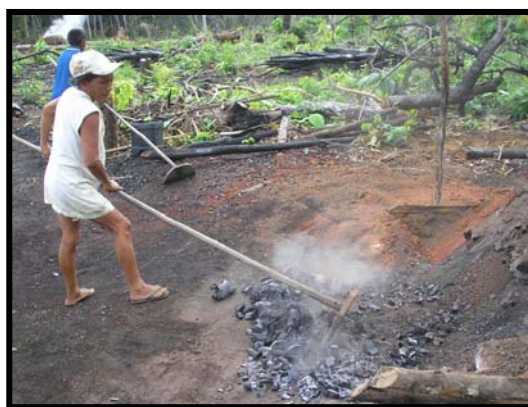
Fig. 4. Separação do carvão da terra da caieira
