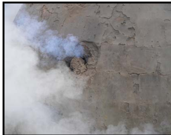
Fig. 12. Fumaça azulada significa que a baiana pode ser fechada.
