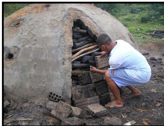
Fig. 8. Fechamento da porta principal antes de acender o forno
