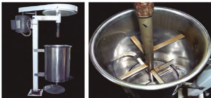
Figura 8. Maquinaria para o processamento da polpa de buriti: (A) Despulpadeira de aço inoxidável e (B) Detalhe da superfície interna da despulpadeira.
