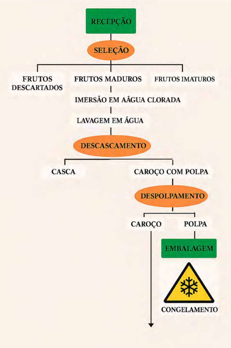
Figura 7. Fluxograma para obtenção da polpa integral de Endopleura uchi .
